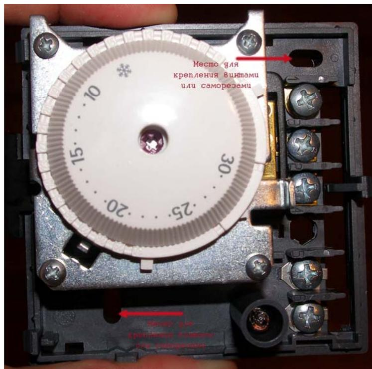
Рис. 3. – Отверстия для крепления термостата.
