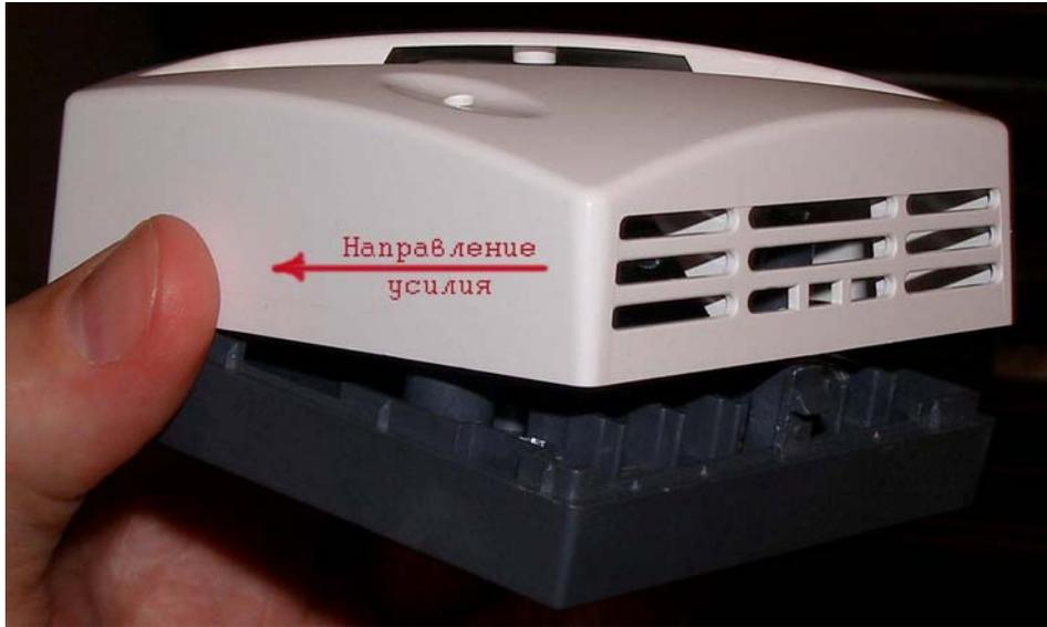
Рис. 2. – Второй шаг для снятия крышки термостата.
