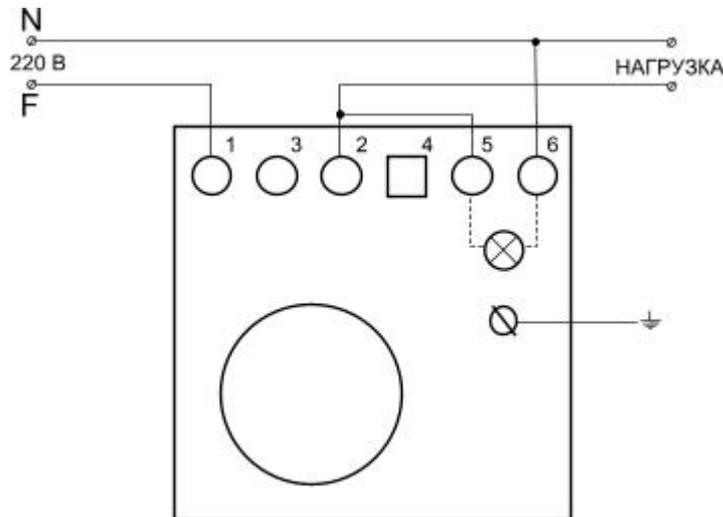
Рис. 4. – схема электрических соединений
